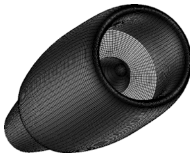
图2 NAL-AERO-02-01 模型表面网格图
